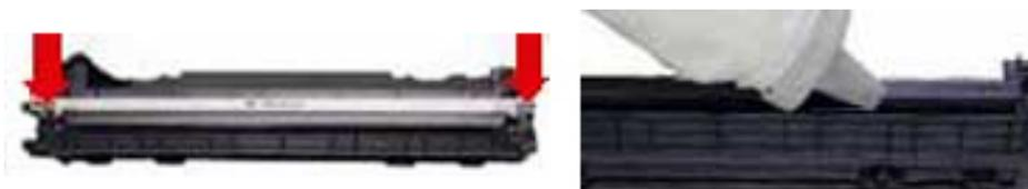
Приступаем к сборке картриджа. Соедините обе части картриджа, вставляя трубчатые шарнирные части в отверстия с обеих сторон картриджа.
