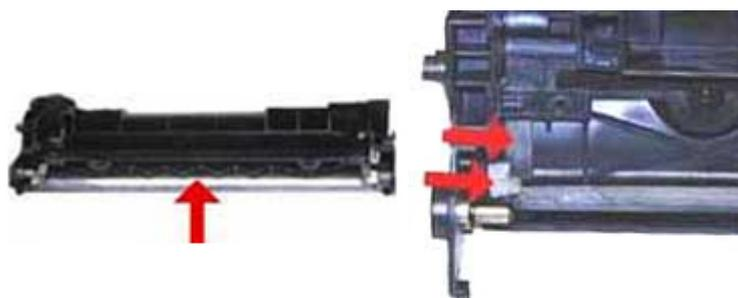
Открутив винт, снимите другую боковую крышку картриджа.
