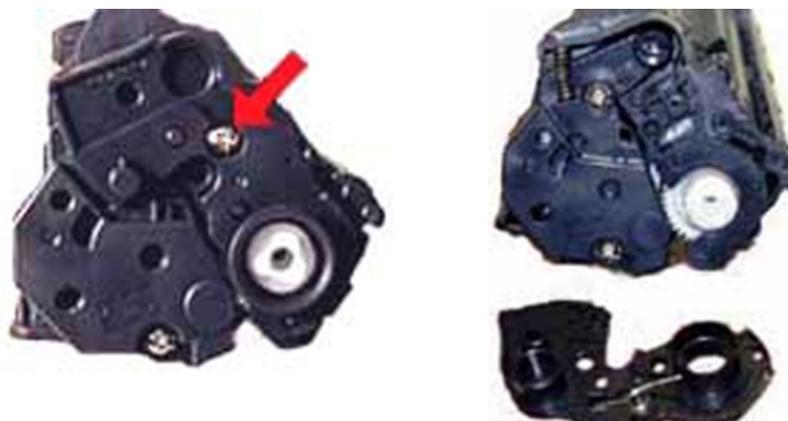
Плоскогубцами снимите пружины.
