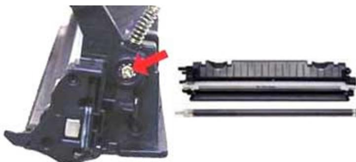
Открутив еще два винта, снимите дозирующее лезвие.
