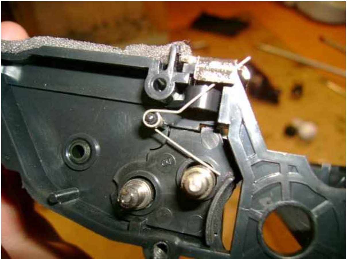
7.Снимаем контактную пружинку.
