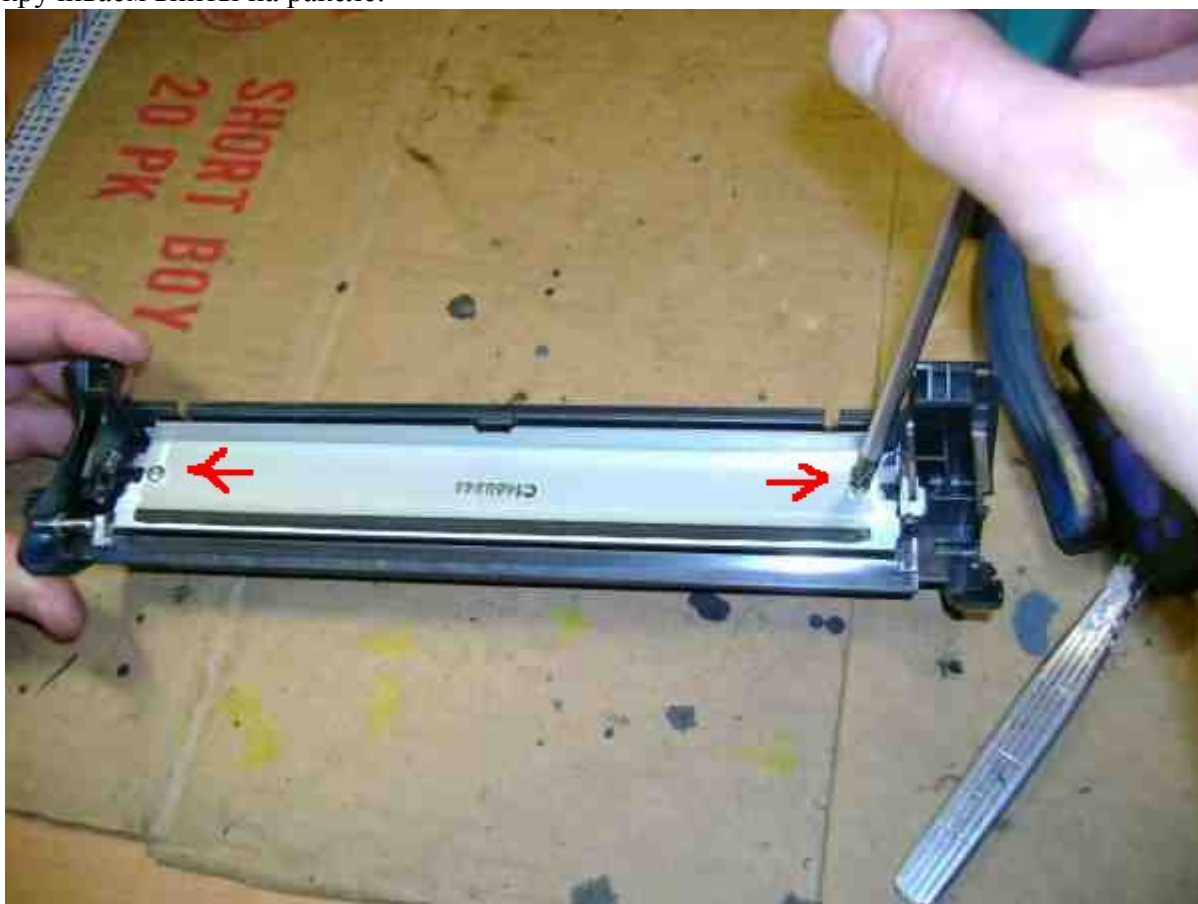
11. Снимаем ракель. Видим кучу отработанного тонера. Высыпаем его. Чистим остатки сервисным пылесосом.
