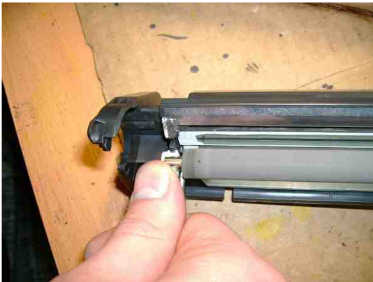
10. Откручиваем винты на ракеле.
