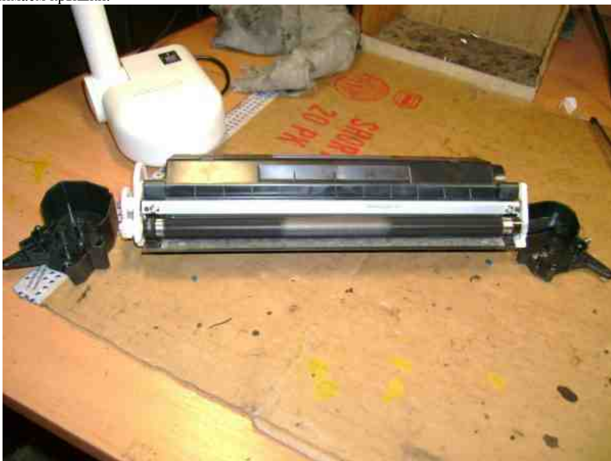
19. Вынимаем магнитный вал.
