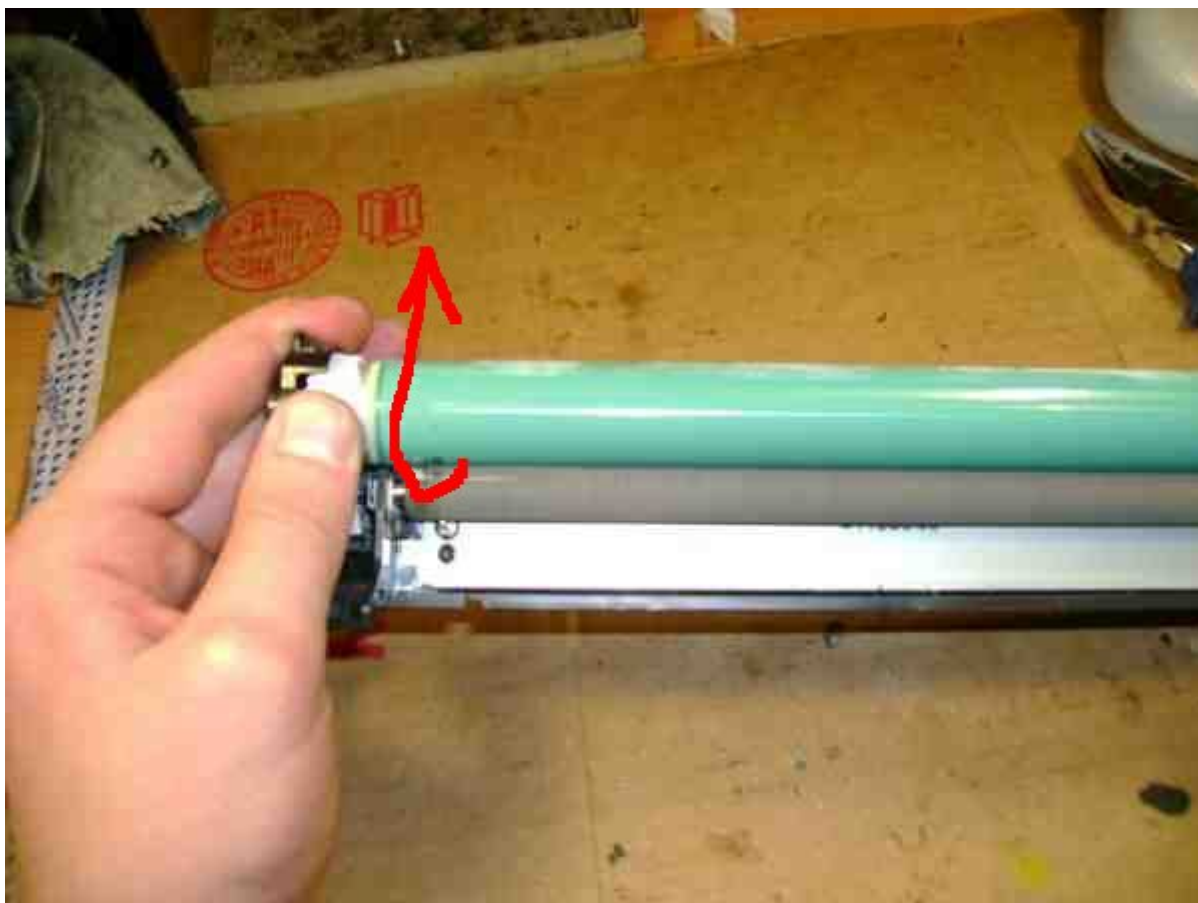
16. Ставим на место и прикручиваем крепление фотовала
