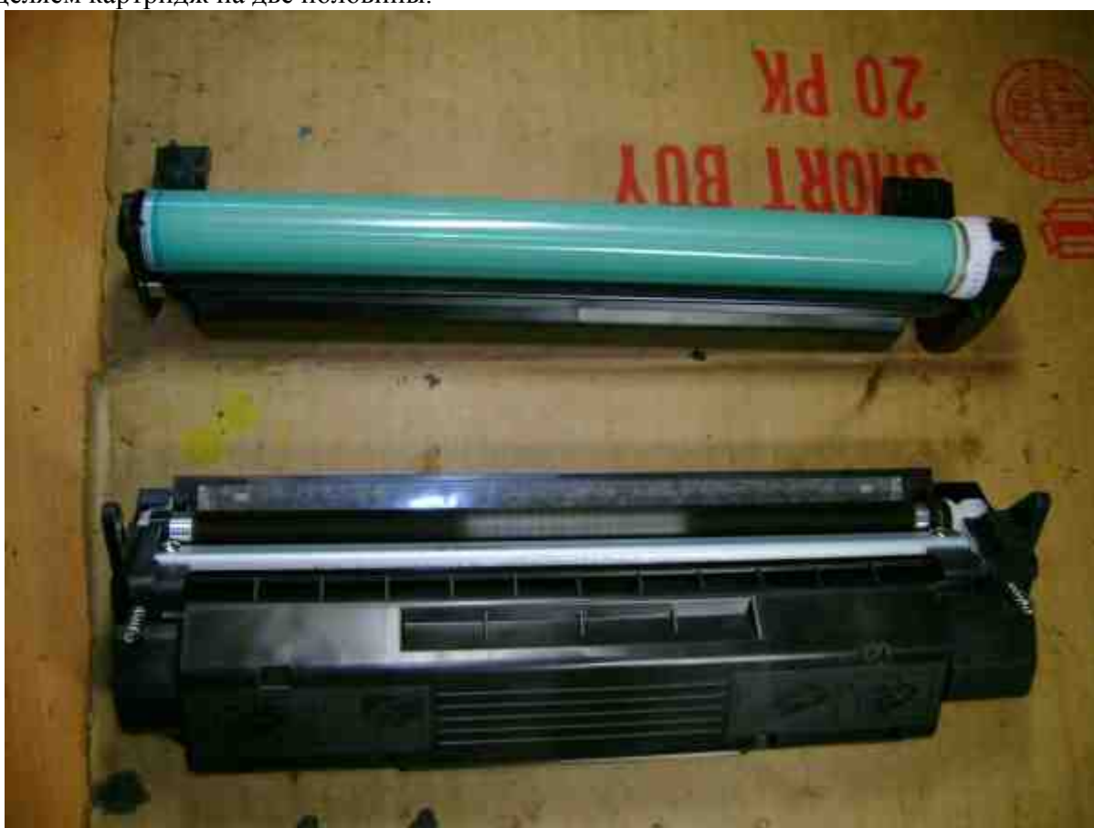
6. Выкручиваем винт, вынимаем крепление фотобара.
