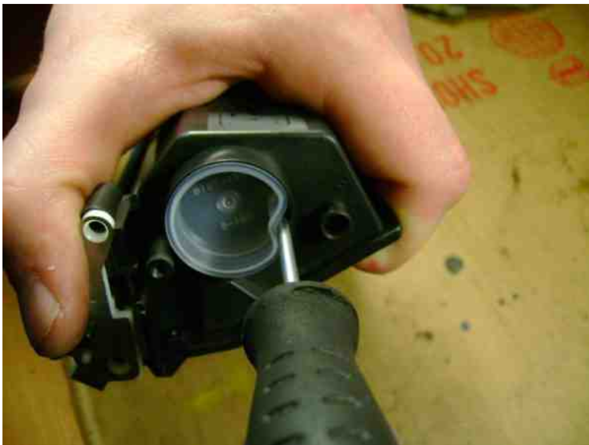
24. Вставляем воронку, засыпаем тонер.
