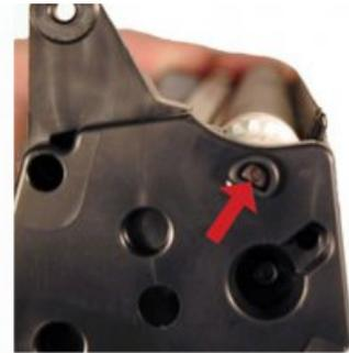
Установите боковую крышку с контактами и два винта. Если крышка не устанавливается, значит - неправильно установлен стационарный магнит. Соедините обе части картриджа. Убедитесь, что пружины установлены и установите 2 штифта (рис. 15).
