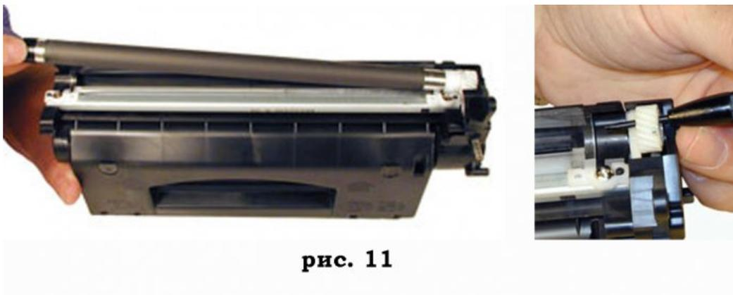
Удалите два винта и снимите дозирующее лезвие.
