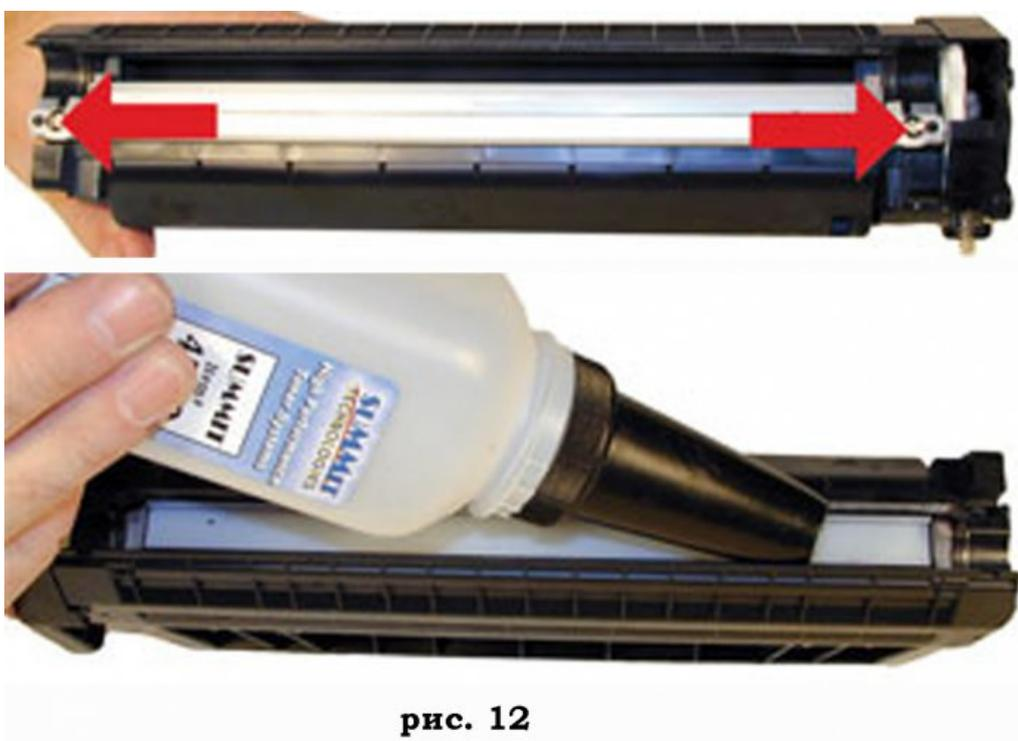
Убедитесь, что чеки дозирующего лезвия чистые. Если они покрыты тонером, аккуратно прочистите их ватным тампоном, смоченном в спирте, пока они снова не станут липкими. Установите дозирующее лезвие и три винта. Прочистите контактную панель магнитного вала на контактной боковой крышке. Замените проводящую смазку. Установите ведущую шестерню магнитного вала. Убедитесь, что скрепляющая часть шестерни смотрит на вал (рис. 13).
