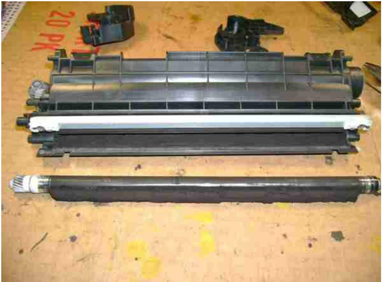
22. Снимаем шестерни. Пылесосим сервисным пылесосом магнитный вал и полость бункера с тонером. Вычищать тонер пылесосом нужно потому что в нем содержится бумажная пыль и прочие крупные частицы попавшие (образовавшиеся) в бункер с тонером. В крайнем случае можно не пылесосить.
