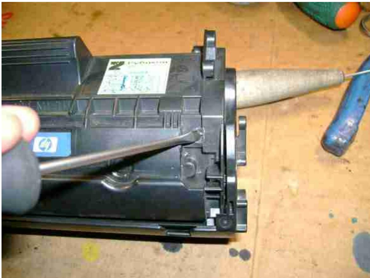
4. !!!ВНИМАНИЕ!!! Снимите пружину стягивающую две половины картриджа. *Ее легко потерять, без нее картридж будет печатать только половину страницы и то бледно. :)*
