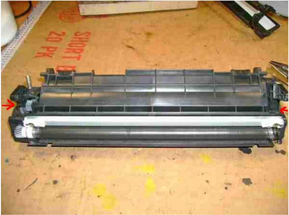
20. Снимаем крышки. 21. Вынимаем магнитный вал.
