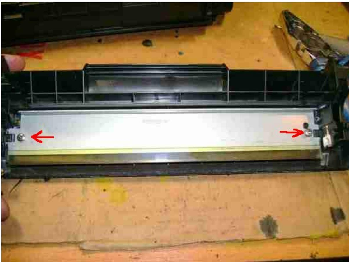
14. Ставим на место вал заряда. 15. Протираем фотовал чистой тряпочкой. Мажем его тальком (можно тонером). Это обязательно. !!!
