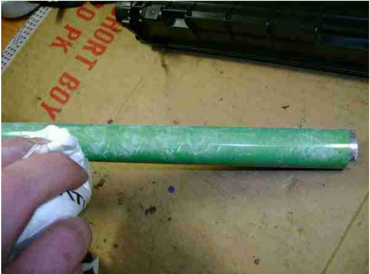
16. Ставим фотовал на место, испачканное тальком (тонером) место должно попасть на кромку ракеля. Тальк (тонер) выступает в роли смазки, без него во время работы ракель завернет на фотовал и картридж работать не будет. 17. Ставим на место шторку фотовала. Не забываем про пружинку.
