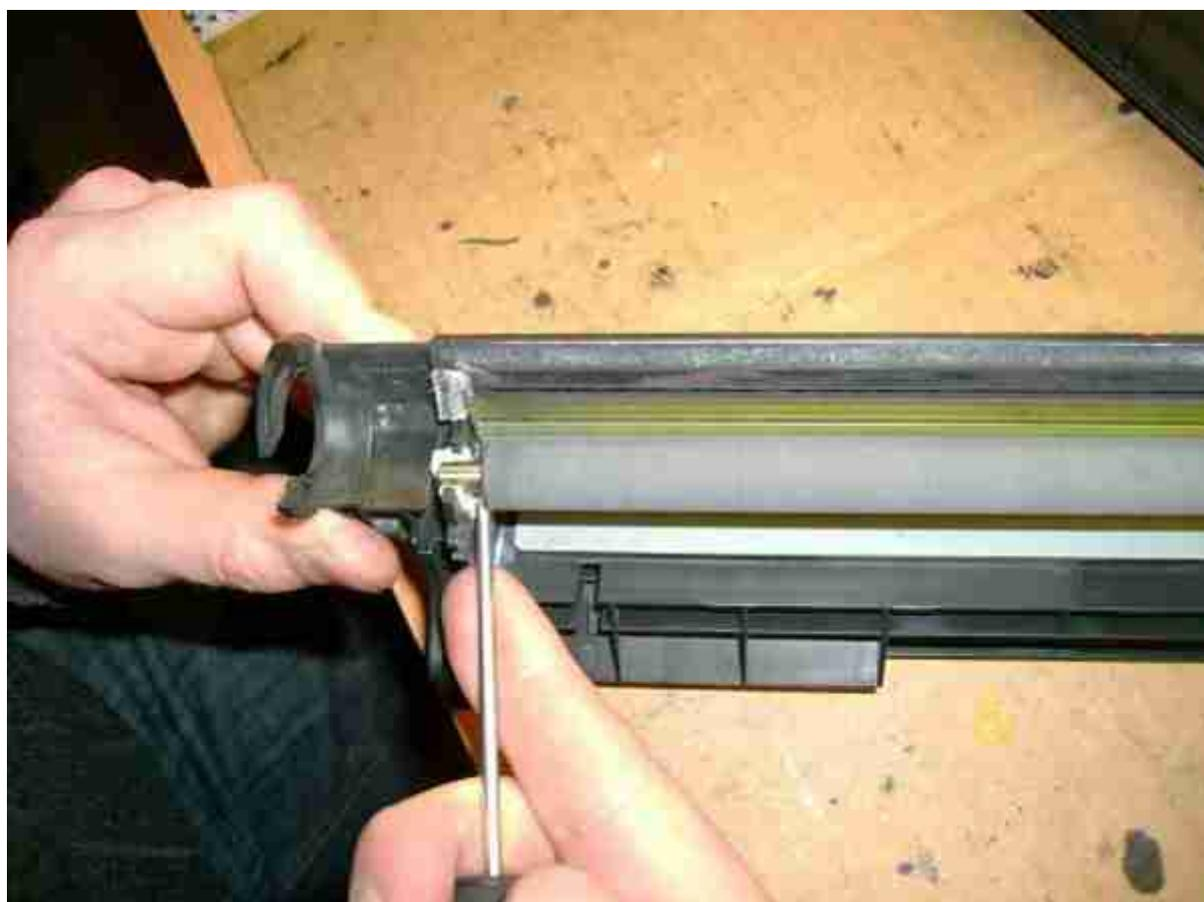
11. Откручиваем винты на ракеле. 12. Снимаем рапель. Видим кучу отработанного тонера. Высыпаем его. Чистим остатки сервисным пылесосом. 13. Прикручиваем рапель.
