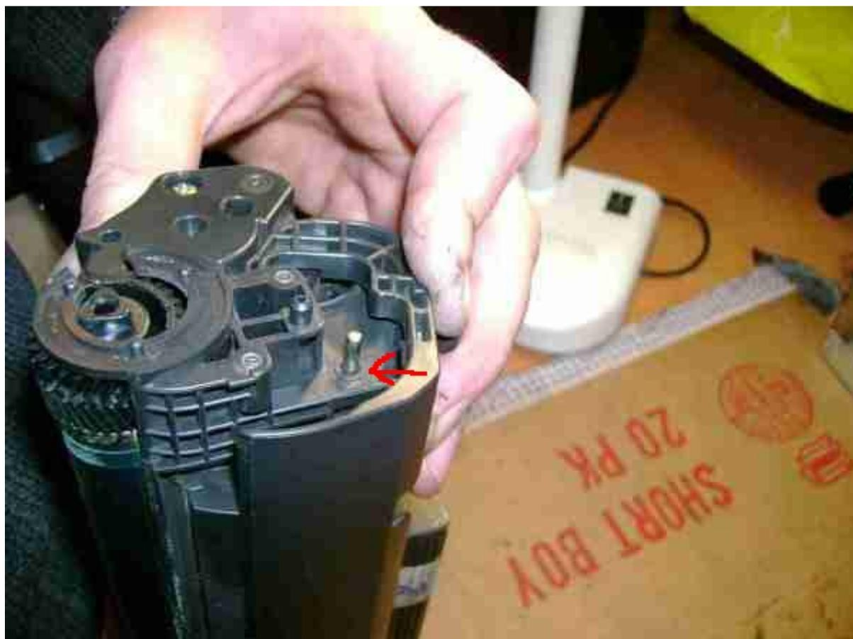
31. Ставим на место крышку-крепление фотовала. Завинчиваем винты.
