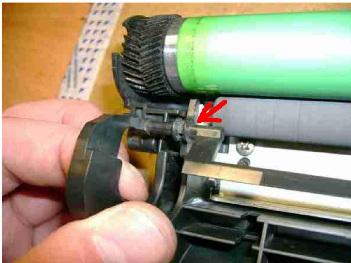
8. Пальцами поднимаем фотовал за шестерню выше выступающих частей корпуса. 9. Отверткой давим в противоположный торец фотовала, снимаем его с оси.
