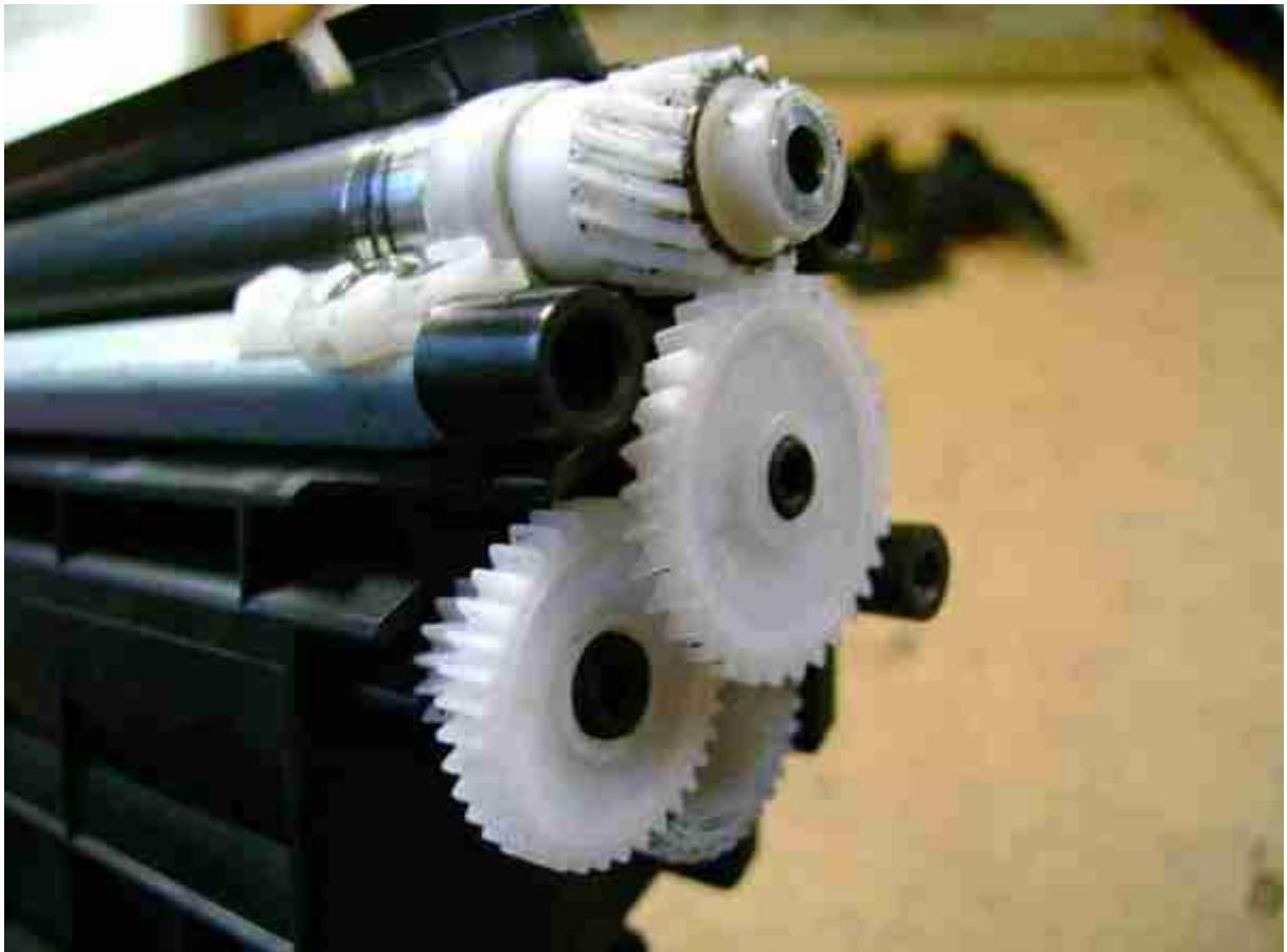
24. Ставим половинку на торец, удерживаем пальцем магнитный вал чтоб он не вывалился. 25. Вставляем отвертку между пробкой и корпусом, проталкиваем отвертку так, чтоб ее конец был дальше пробки, зажимаем пробку между пальцем и отверткой, вытаскиваем ее. *Пробка сделана из мягкой пластмассы - не проткните ее. Лично я вытаскиваю пробку, цепляясь ногтями за ее кромку.*
