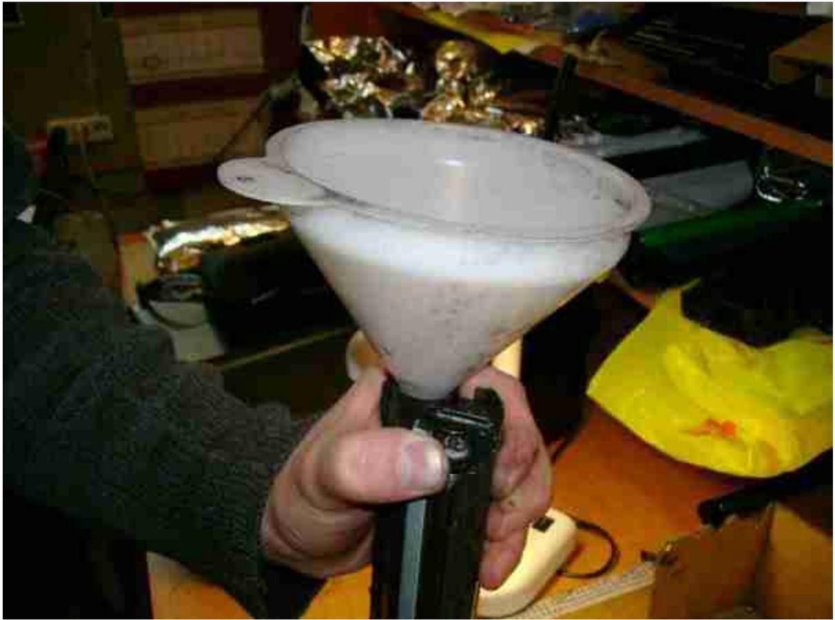
27. Втыкаем пробку на ее законное место. 28. Прикручиваем крышку со стороны пробки. *Устанавливая крышку следите за пружинкой-контактом на магнитном вале, старайтесь не защемить и не погнуть ее. Не забываете удерживать магнитный вал пальцем. Вывалится – замучаетесь тонер собирать.* 29. Соединяем половинки. 30. Отодвинув шторку фотовала, вставляем штифты на место.
