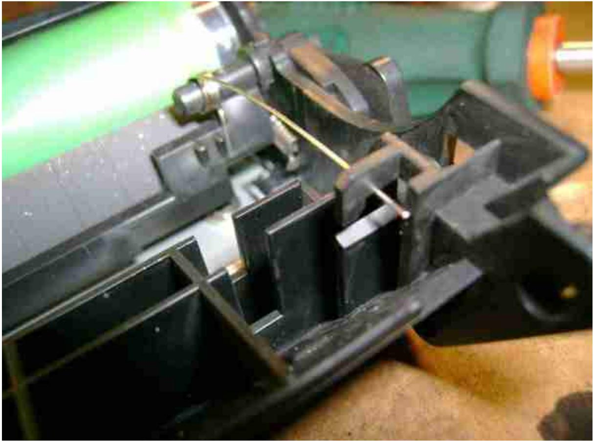
18. Убираем половину картриджа с фотовалом. *Крышку-крепление фотовала закрепим после того как соединим половинки.* 19. Берем другую половину картриджа. Откручиваем винты, крепящие крышки на торцах.
