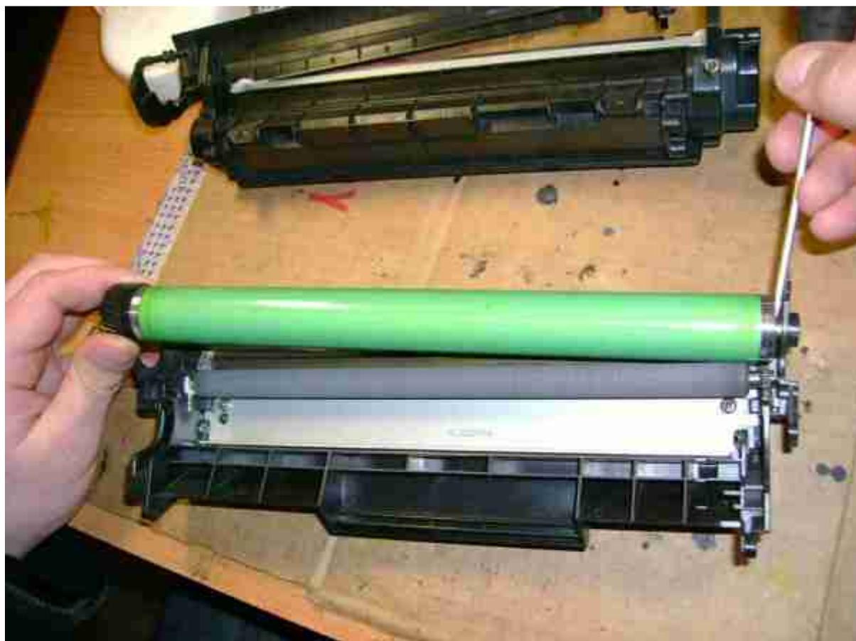
10. Подцепляем отверткой вал заряда, вытаскиваем его из крепления.
