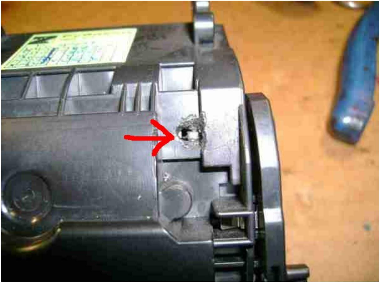
2. Далее откручиваем два винта на крышке-креплении фотовала, она закрывает доступ к штифту.
