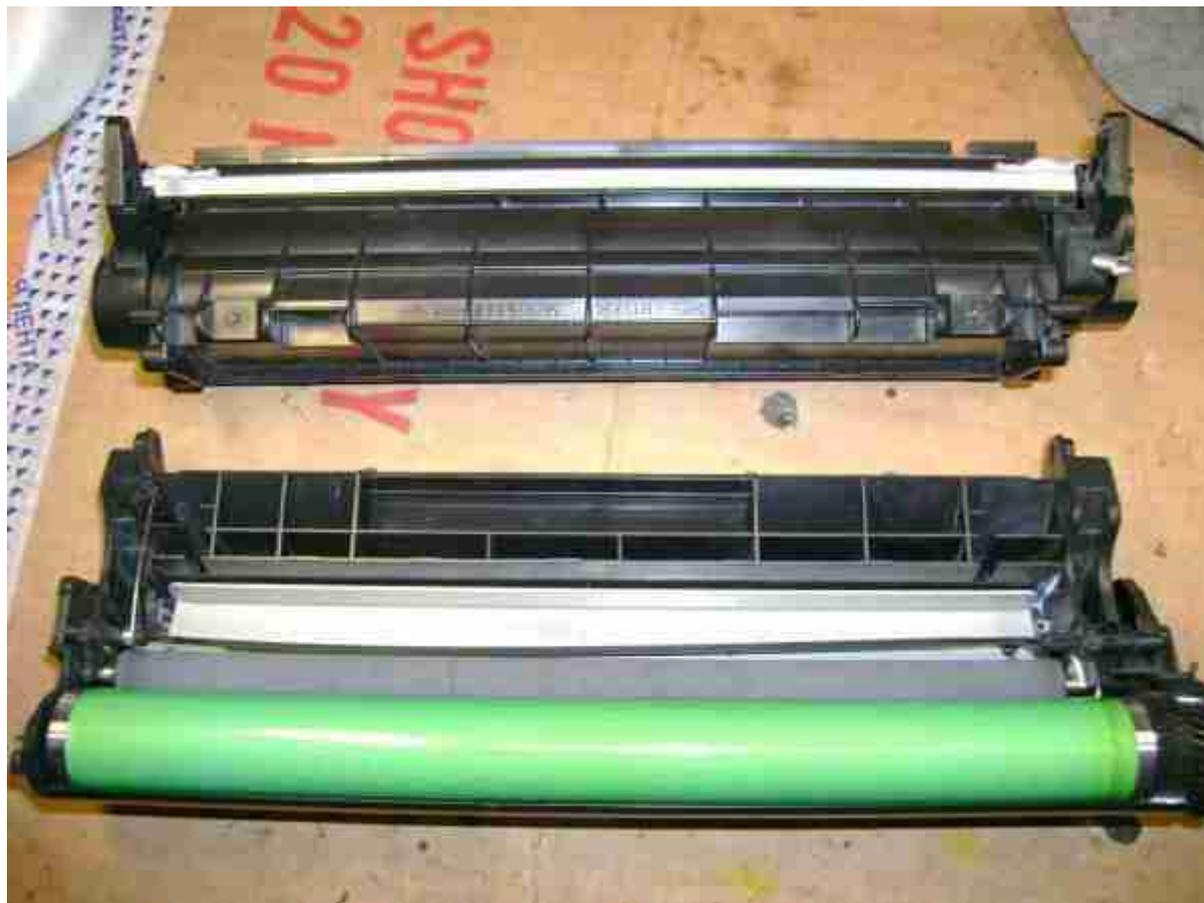
7. Снимаем шторку фотовала повернув ее в креплении. Вынимать без усилий.
