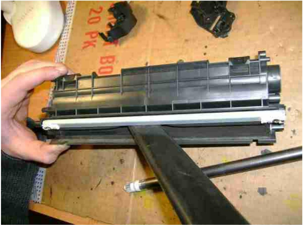
23. Ставим шестерни и магнитный вал на место, прикручиваем крышку со стороны шестеренок.
