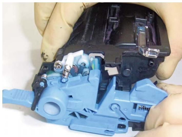
Снимите стягивающие пружины и разделите картридж на две части.
