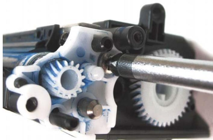
Откручиваем винты, которые держат лезвие подбора, снимаем его и протираем сухой чистой тряпкой.
