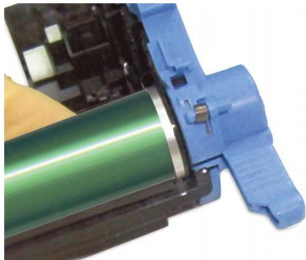
Вставляем отвертку и проверяем чтобы втулка ровно встала и защелкнулась.
