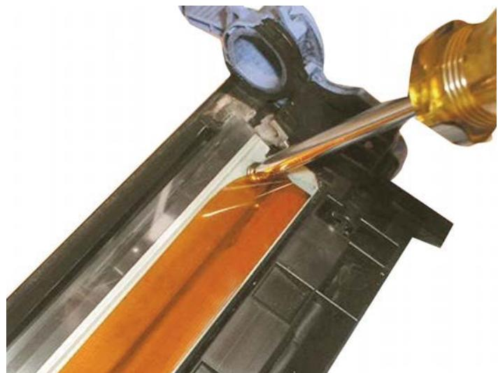
Очищаем черную втулку от грязи и наносим токопроводящую смазку.
