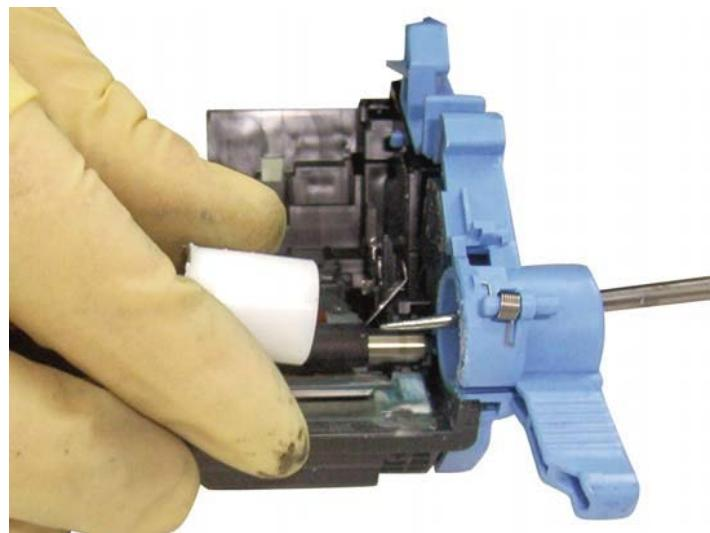
Снимите ролик заряда и протрите его сухой чистой тряпкой.
