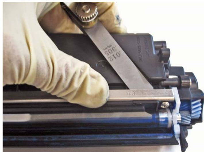
Откручиваем справа два винта и снимаем белую контактную пластину.
