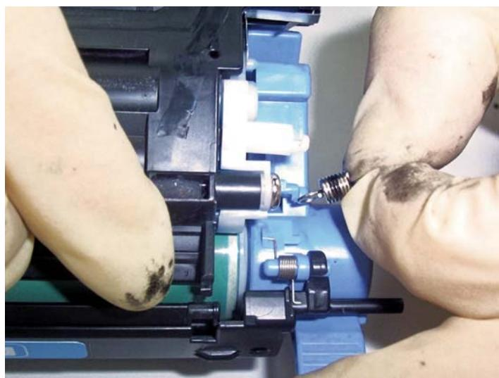
Соединяем две половины шторки фотобарабана и крепим ее на картридж.
