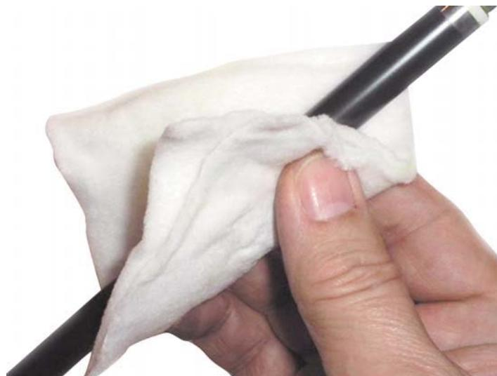
Тщательно удаляем остатки старого тонера и засыпаем новый. Для Q6000A - 85 грамм, для Q6001A / Q6002A / Q6003A - 70 грамм.
