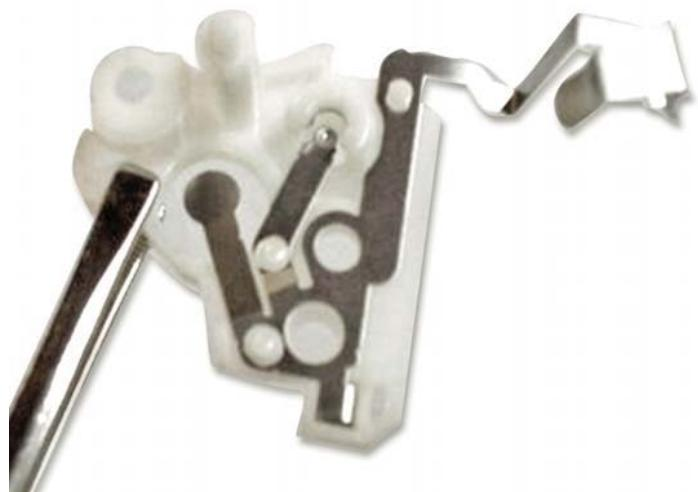
Теперь откручиваем два винта слева и снимаем крышку и шестерни.
