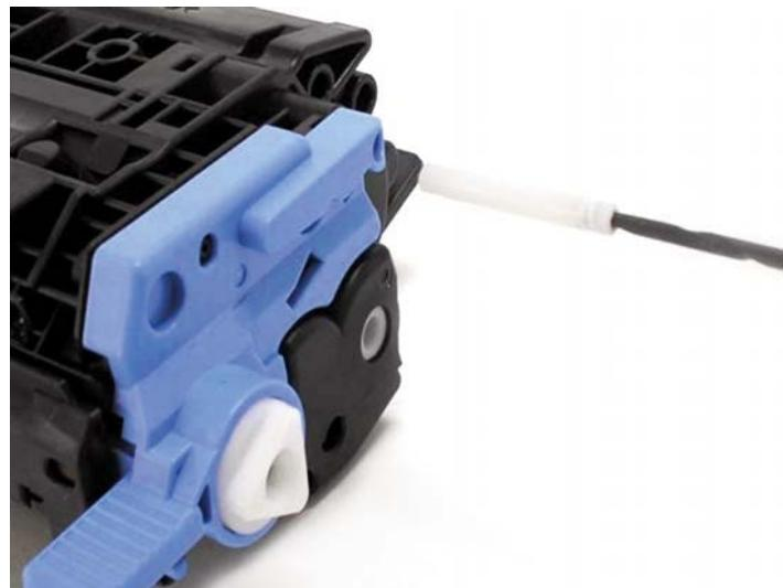
Снимите часть защитной шторки фотобарабана.
