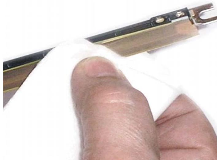
Снимаем и протираем чистой тряпкой вал переноса.
