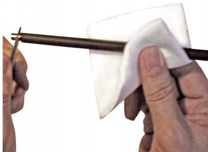
Открутите два винта, снимите лезвие очистки и протрите его сухой чистой тряпкой.
