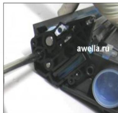
20. Выкручиваем два винта и снимаем пластину поддержки ролика.
