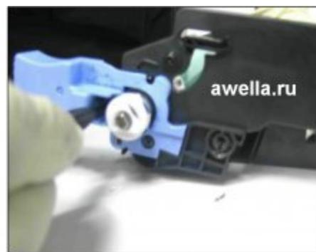
41. Выкручиваем два винта из держателя с другой стороны картриджа.
