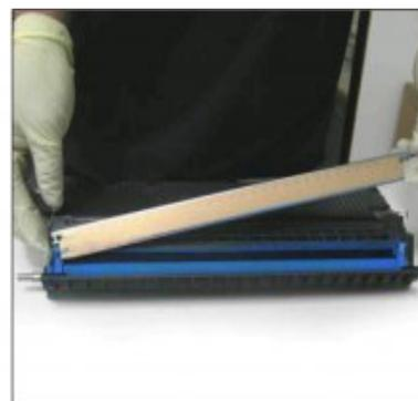
25. Отворачиваем винты чистящего лезвия с обеих сторон.
