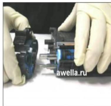
18. Снимаем два винта и снимаем пластину поддержки механизма как показано на рисунке.
