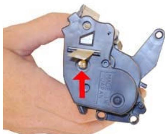
Установите вал переноса, предварительно очистив его сухой чистой тряпкой.
