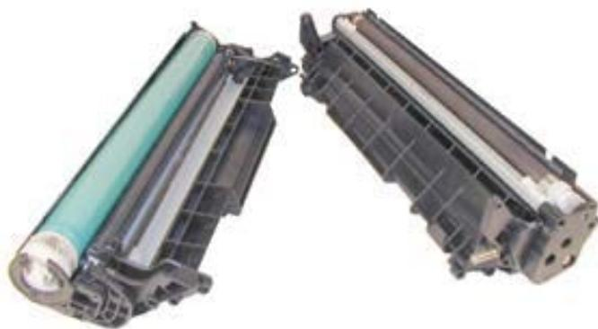
На левой части удалите фотобарабан и ролик заряда.
