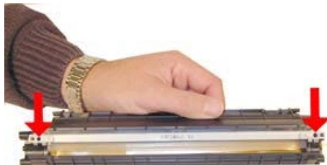
Смажте токопроводящей самзкой контактную пластину на левой крышке и установите ее, закрепив винтом.
