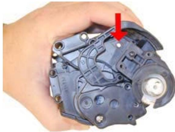
Установите крепление фотобарабана и закрепите его двумя винтами.
