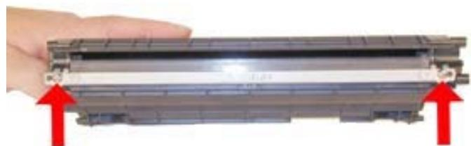
Вытащите пробку, удалите из картриджа остатки старого тонера и вставьте пробку на место.
