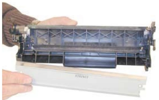
Установите обратно лезвие очистки, ролик заряда и фотобарабан.
