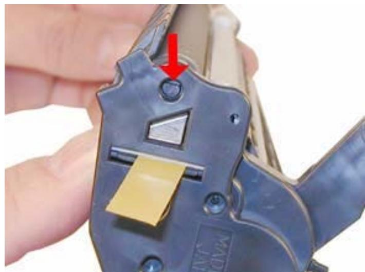
Установите шестерни и правую крышку, закрепив ее винтом.
