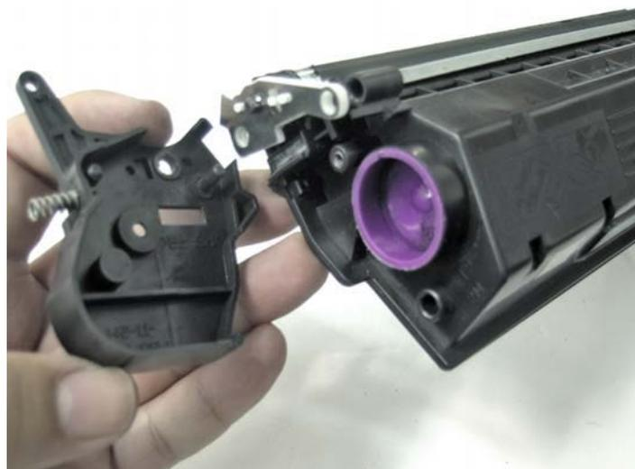
Снимаем вал переноса.
