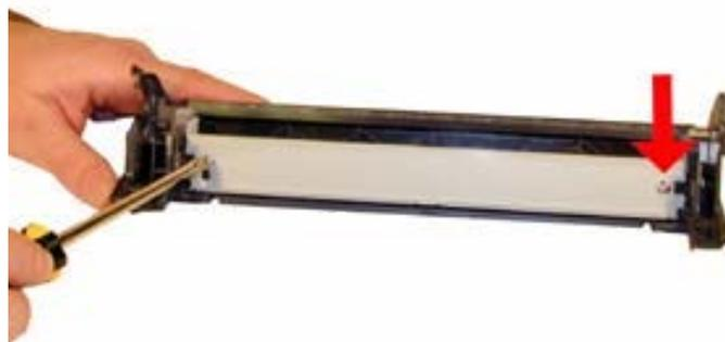
Очистите гнезда ролика заряда от грязи и установите его.
