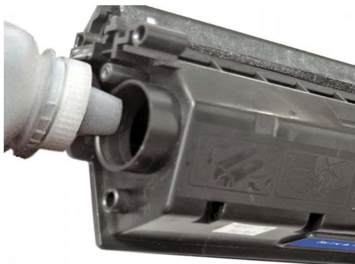
Вставляем пробку и одеваем левую крышку.
