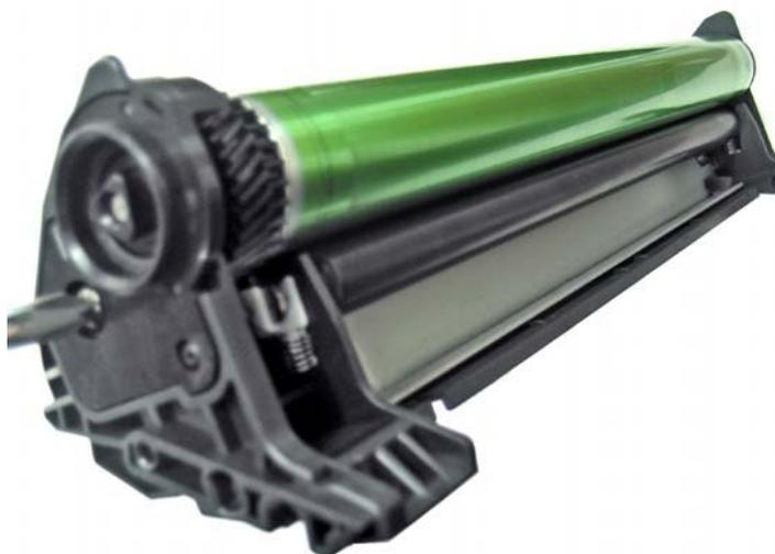
Теперь удалите крепление, фотобарабан и ролик заряда.
