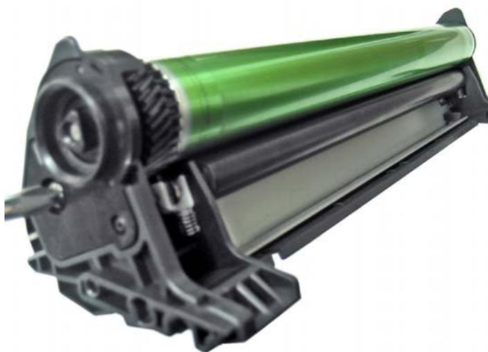
Переходим ко второй части: Откручиваем справа один винт и снимаем крышку и шестерни.
