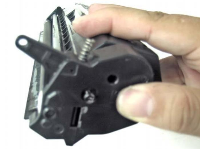
Соединяем обе половины картриджа и скрепляем их штифтами.
