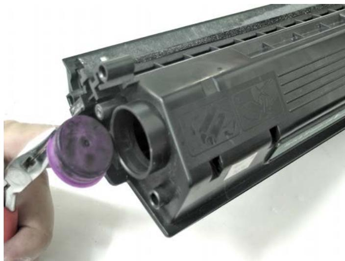
Тщательно очищаем картридж от остатков старого тонера и устанавливаем обратно лезвие подбора.
