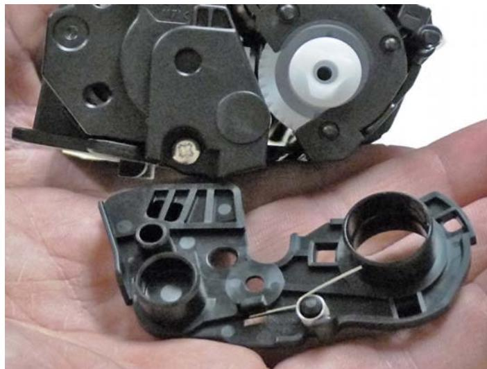
Отгибаем пружины как показано на рисунке, и, движением в сторону от оси фотобарабана, разбираем картридж на две части.
