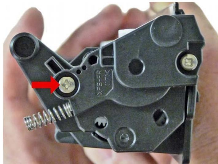
Соединяем обе части и выставляем распорные пружины в правильное положение.
