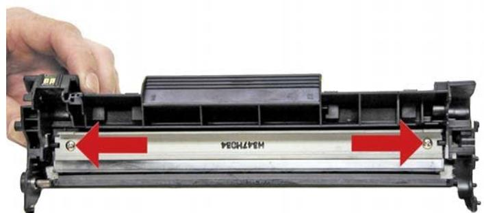
Устанавливаем на место фотобарабан и вал заряда, предварительно смазав их посадочные гнезда токопроводящей смазкой.
