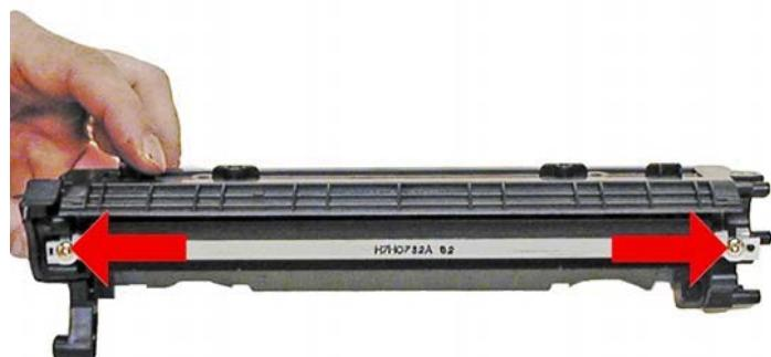
Правильно установите вал переноса и шестерни, оденьте правую крышку и закрепите ее фиксатором.
