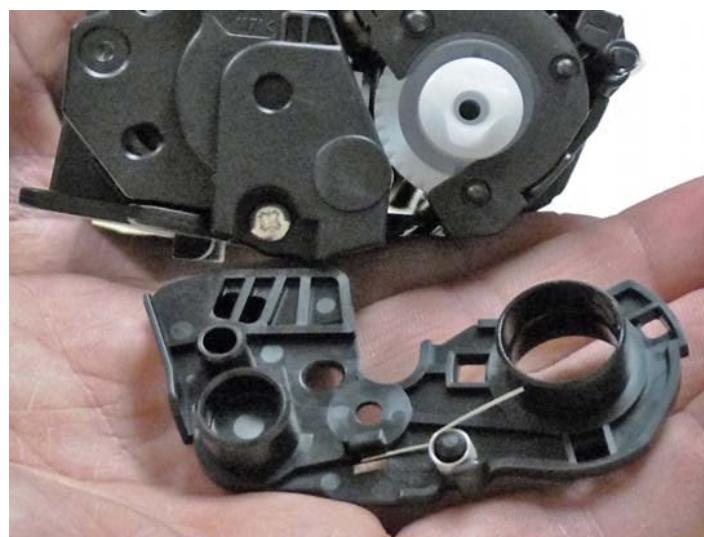
Отгибаем пружины как показано на рисунке, и, движением в сторону от оси фотобарабана, разбираем картридж на две части.
