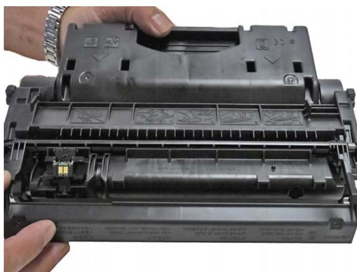
Замените чип при необходимости (Чип на этом картридже не блокирует работу, но при каждом включении будет просить заменить картридж).
