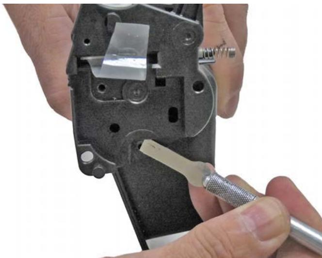
Затем на их месте высверливаем неглубокие отверстия, чтобы потом использовать их для крепления винтами.
