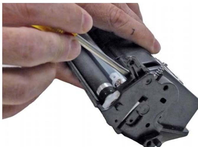
Теперь снимите вал переноса и очистите его сухой чистой тряпкой.
