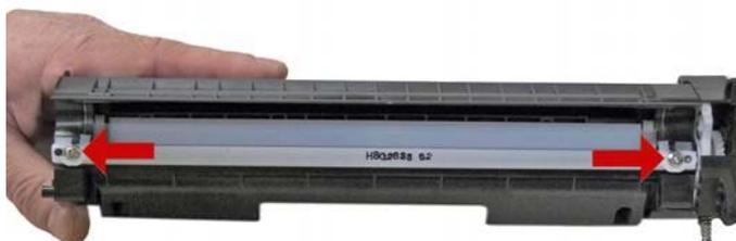
Очистите поверхность контактной пластины и нанесите токопроводящую смазку.
