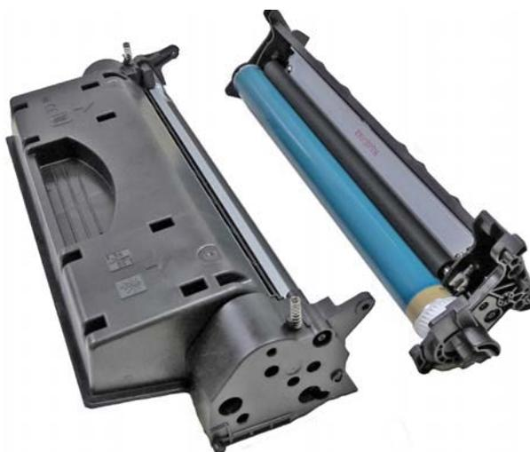
С помощью плоской отвертки надавите на штифт фотобарабана, как показано на рисунке, а затем удалите его, при помощи кусачек.
