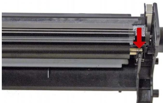
Устанавливаем фотобарабан и закрепляем его штифтом.
