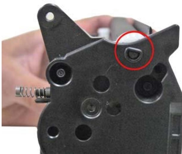
Установите крышку и зафиксируйте ее двумя небольшими саморезами.
