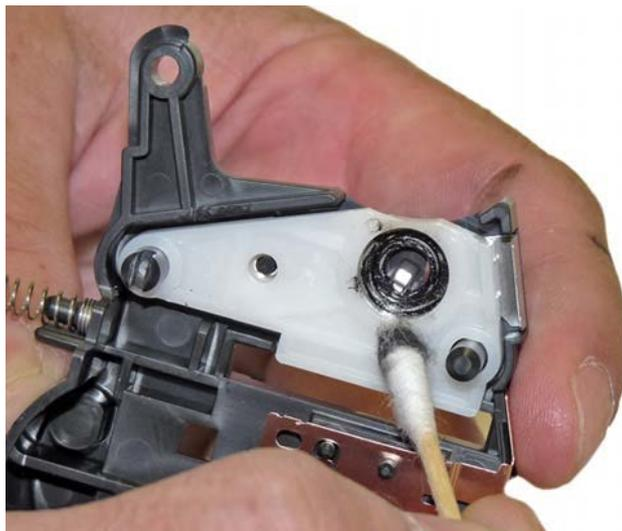
Установите шестерню привода вала переноса.
