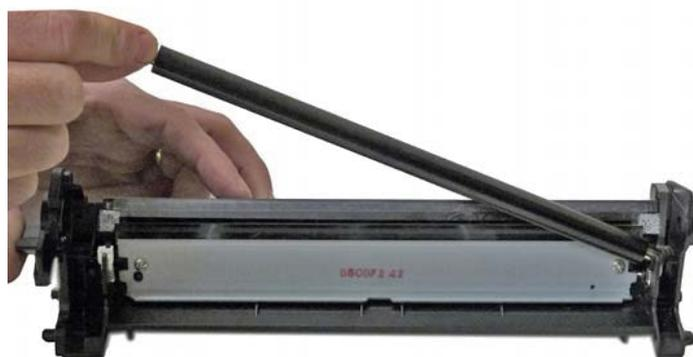
Затем открутите 2 винта и снимите лезвие очистки. Удалите отработанный тонер и установите лезвие на место.
