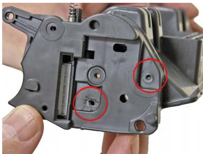
Вставьте плоскую отвертку в зазор между бункером и крышкой. Надавите в сторону с небольшим усилием, чтобы снять крышку.
