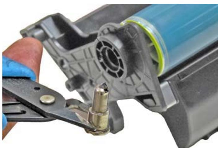
Удалите фотобарабан и ролик заряда.
