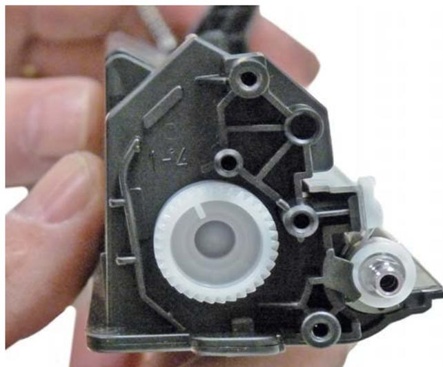
Затем откручиваем один винт слева и аккуратно снимаем вал переноса, следя за тем, чтобы не потреять черную втулку.
