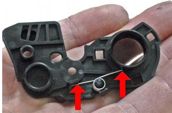
Установите крышку, придерживая пружину пальцем и зафиксируйте ее винтом.
