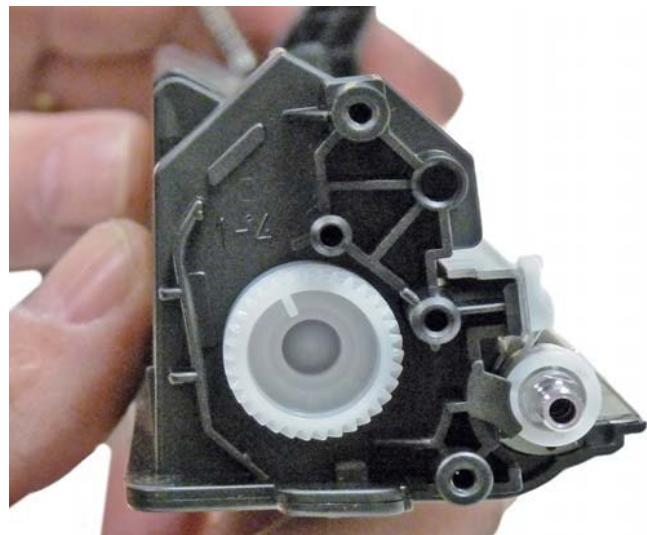
Затем откручиваем один винт слева и аккуратно снимаем вал переноса, следя за тем, чтобы не потерять черную втулку.
