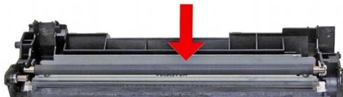
Откручиваем два винта и снимаем лезвие очистки. Удаляем отработанный тонер, сохранив в чистоте уплотнители и устанавливаем лезвие на место.
