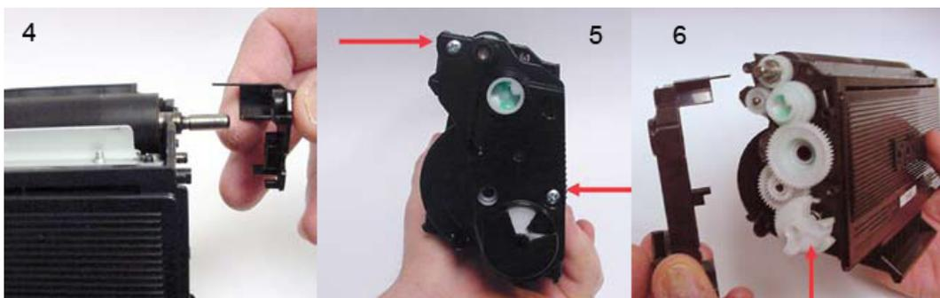
7. Снимите чёрный колпачок, расположенный на конце вала проявки на стороне с шестернями (рис. 7).
