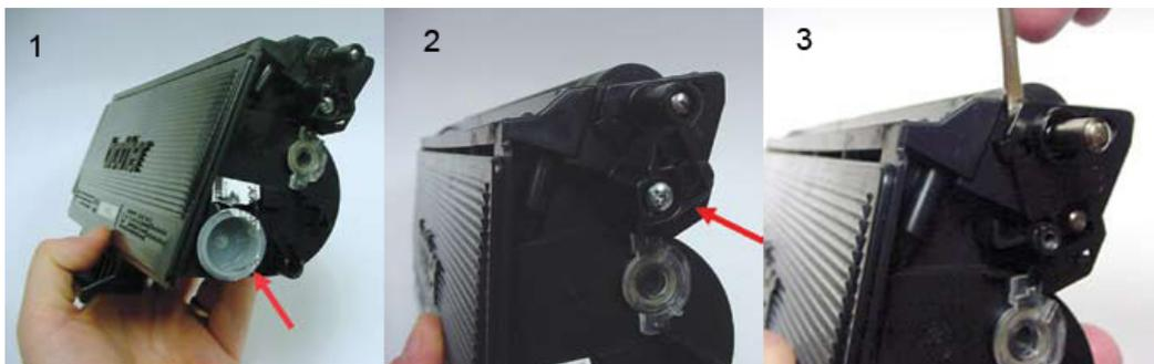
4. Отсоедините стабилизатор вала проявки от вала проявки (рис. 4).
