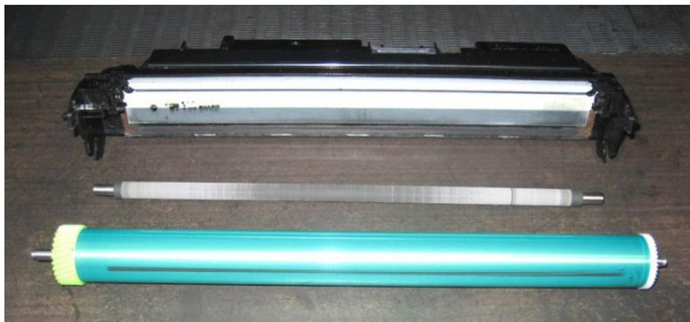
На фото: разобранная часть с фотобарабаном. бункер, ролик заряда (PCR), фотобарабан. Бункер имеет резиновый (ракель) и майларовый (прозрачная полоска в плотную с фотобарабаном) уплотнители. Их необходимо протереть если они загрязнятся после того как отработанный тонер весь вытряхнут из бункера. PCR необходимо аккуратно протереть салфеткой. Не применяя никаких моющих средств. если есть жировые загрязнения, то возможно его просто отмыть водой при помощи бытового нейтрального
