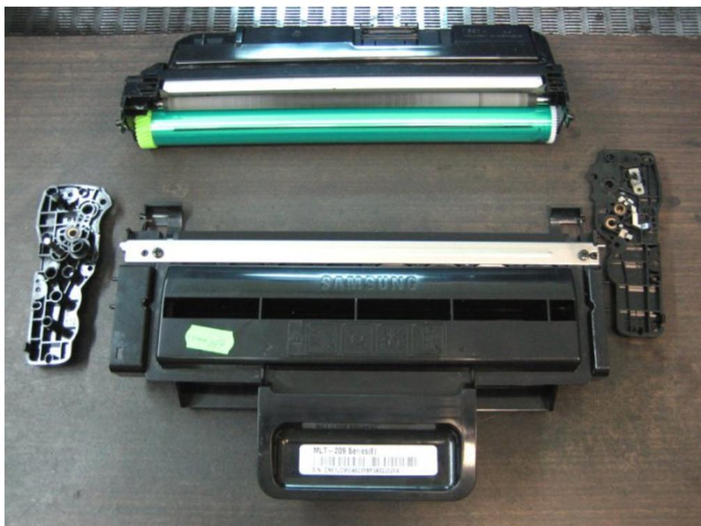
Далее следует открутить боковины. Они закручены на винты. Аккуратно отделив боковины, картридж можно разделить на две половины. Часть с фотобарабаном, и часть с бункером тонера и деталями переноса. Будьте аккуратны и не трогайте валы.
