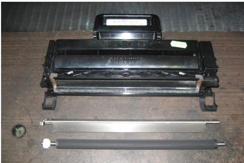
На фото: разобранная часть с бункером тонера. Непосредственно бункер, дозирующее лезвие, вал переноса. В бункере в открывшееся отверстие виден вал подмеса тонера. В открывшуюся же щель надо обязательно вытолкнуть пробку, через которую в последствии будет засыпан тонер. Открыть пробку на другом этапе затруднительно. Также необходимо правильно вычистить дозирующее лезвие. Для этого его кромку, прикасающуюся к валу переноса необходимо протереть салфеткой и главное, протереть
