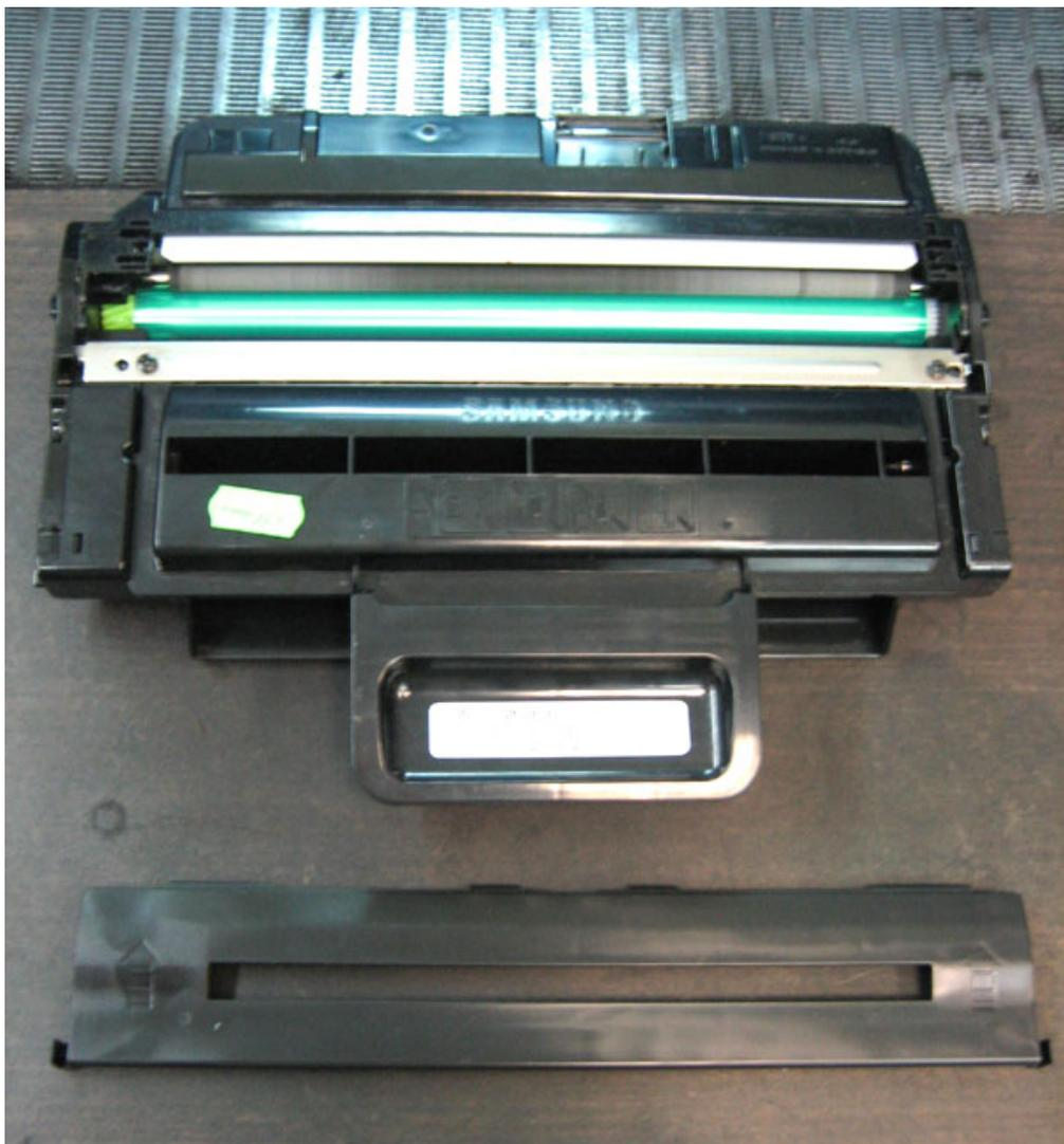
Для начала необходимо просто снять крышку с верху картриджа. Она крепится двумя защелками в боков. Их надо просто нажать. Сама крышка несет только эстетический функционал. На фото стартовый картридж, и сразу видно отсутствие чипа и разделенный на двое бункер для тонера. Собственно это всё отличие от картриджа стандартного объёма.
