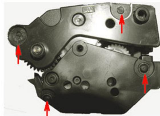
Снимаем боковые крышки, для этого срезаем выступы технологической спайки показанные стрелками острым канцелярским ножом, затем аккуратно плоской отверткой оторываем боковые крышки от основного корпуса картриджа, как показано на рисунке.
