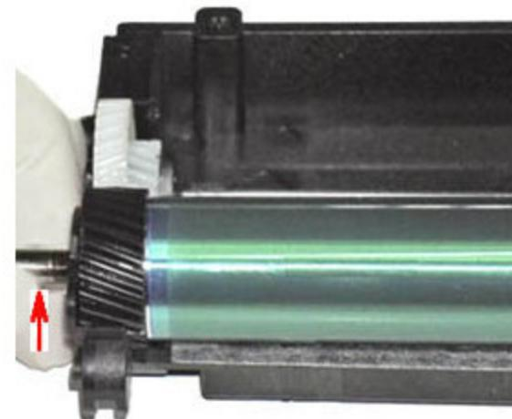
Далее разделяем картридж на 2 половины. Будьте внимательны не потеряйте две пружины, стягивающие две половины картриджа. Когда будете располовинивать картридж - эти пружины могут улететь. Затем вытаскиваем на себя металлическую ось, которая фиксирует фотобарабан (см. показано стрелкой). Извлекаем из картриджа фотобарабан.
